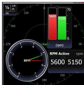
Аналоговый датчик показывает RPM по двум двигателям
